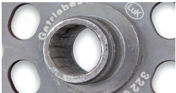
画像 2：破損したスプラインプロフィール
